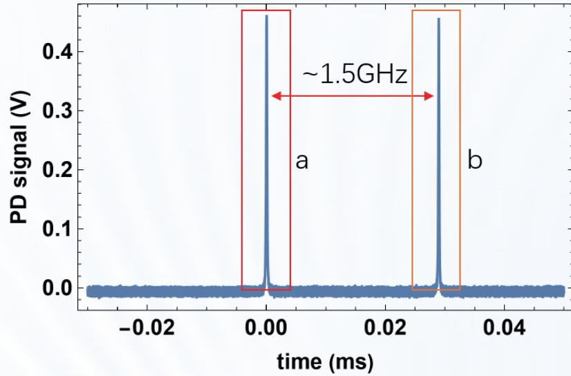
采用780nm激光扫频时透射PD信号，注意此时没有进行仔细模式匹配，因此峰间隔1.5GHz左右。
