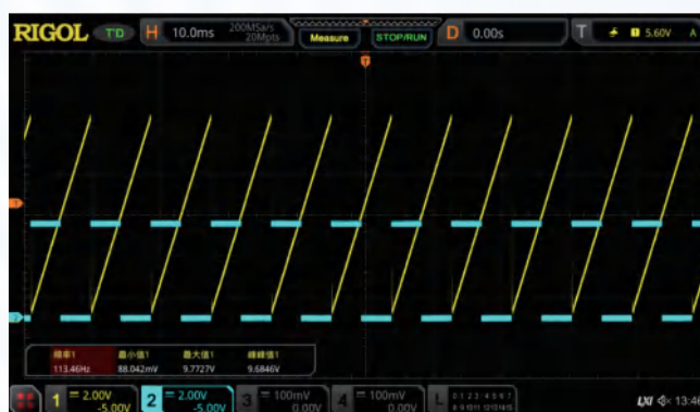
输出1倍扫频变焦下10V锯齿波（黄）与5V Trigger（蓝）输出
